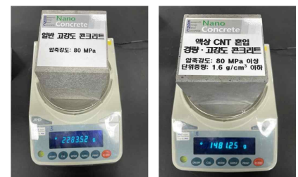
< 콘크리트 단위용적중량 저감(좌→우) >
