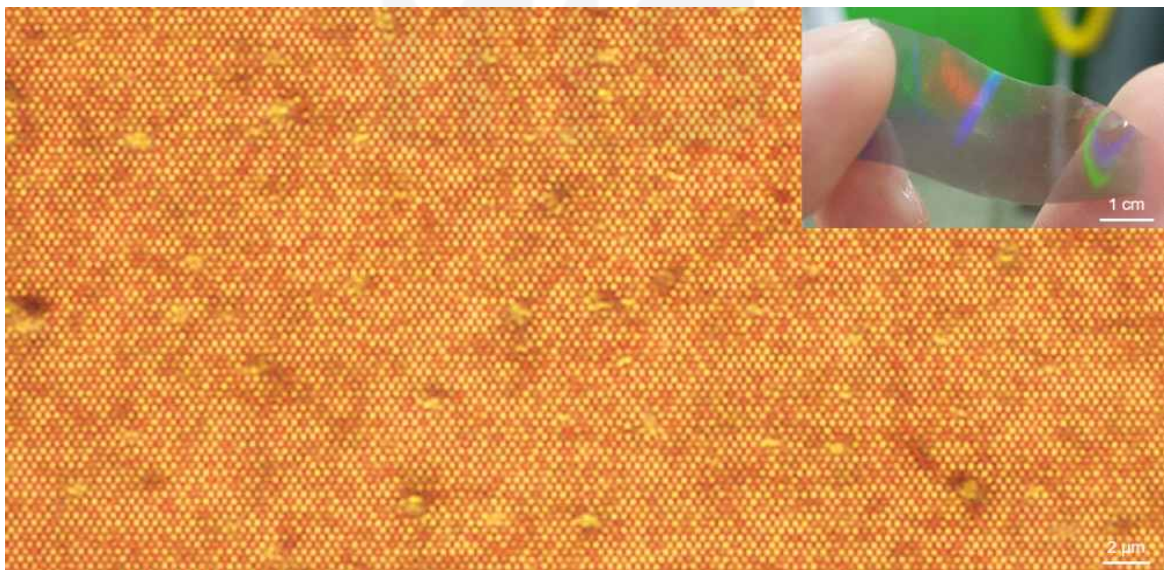
< 그림 38 > 카이랄 금 나노 입자의 규칙적 조립 구조의 암시야상 현미경 사진과 실제 소자의 사진
