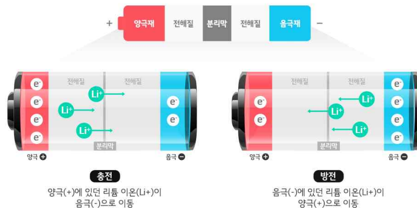
[그림] 리튬이온전지의 원리 (출처: LG에너지솔루션)
