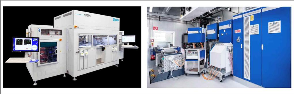
[그림 3-4] 반도체 ATE 장비 및 차량용 배터리 ATE 장비 예시
