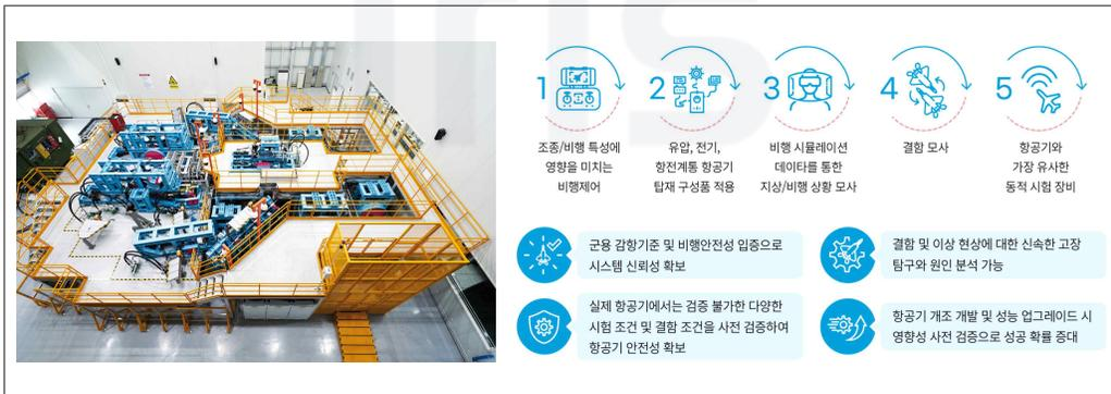
[그림 3-2] KF-21 전투기 아이언버드 - 전자식 비행제어계통 검증 시스템
