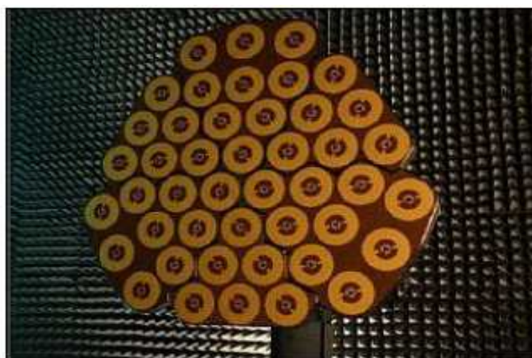
그림 59 Helix Type 안테나 제작 예
